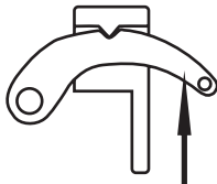
Рис. 1 – Положение переключателя при подъеме груза
